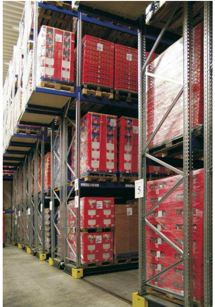
Das Nürnberger Kühlager von Lambert ist mit Verschieberegalen – gesteuert durch ein Aisys-LVS-System – ausgestattet
