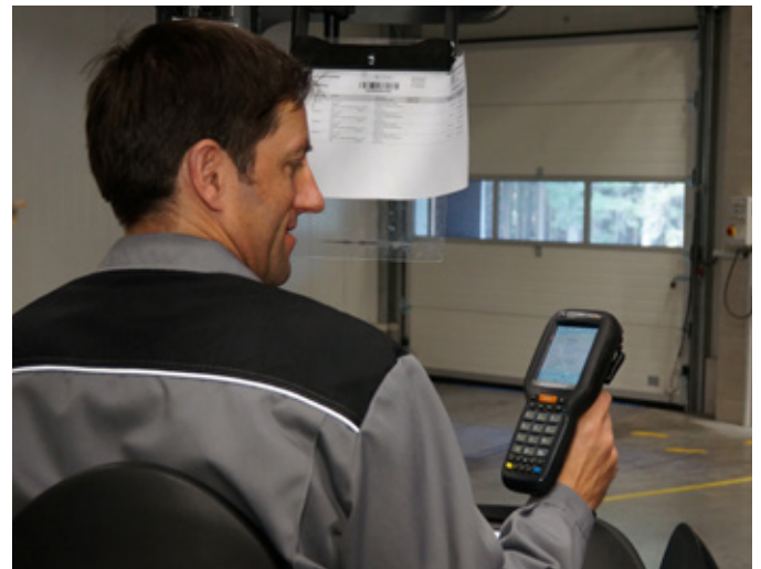
... wo jeder Lagermitarbeiter mit einem mobilen Handterminal mit Scanner ausgestattet ist. Auf den Geräten vom Typ Datalogic Falcon läuft eine MDE-Browserlösung von xStorage , die direkt auf die Datenbank zugreift und den exakten Handlungsablauf vorgibt.
